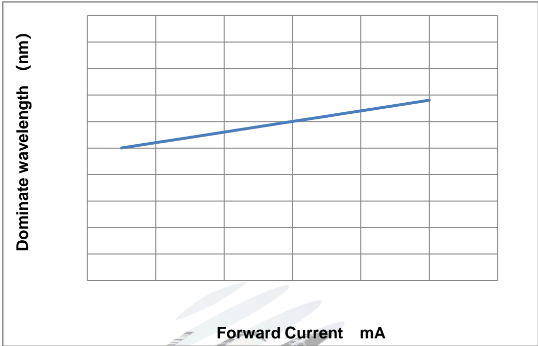
Fig. 1-13 Forward current vs. Dominate wavelength 正向電流與波長特性曲線 (Ts=25°C)
